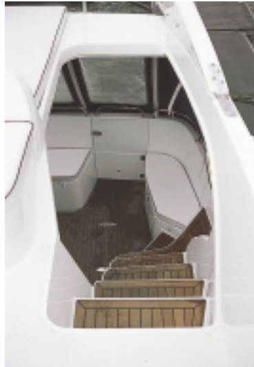
Tolle Lösung: Die Fly wird über ein in die GFK-Form integriertes Treppenhaus erreicht. Im Hintergrund erkennt man die nach innen öffnende Eingangstür, die Badeplattform und Cockpit verbindet
