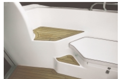
Praktisch: In die GFK-Form eingefügte Trittschritte erleichtern den seitlichen Einstieg ins Cockpit
