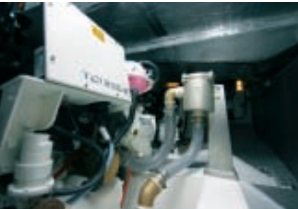
Von der Basis her sind es V6-VW-Marine-Diesel mit 195 kW (265 PS). Wegen der Bodenseezulassung allerdings per Steuergerät auf 169 kW (230 PS) gedrosselt. Mehr ist auf dem Schwäbischen Meer bei Doppelmotorisierung nicht drin.
