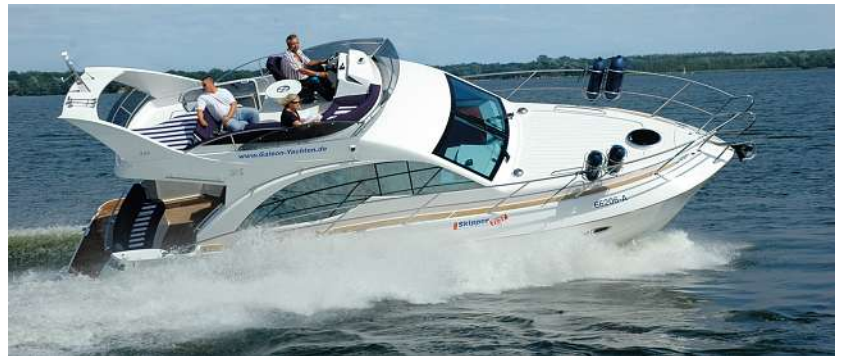
In forciertem Kurvenfahrt neigt die komplett handlaminierte polnische Luxusyacht zu heftiger Krängung über die Längsachse
