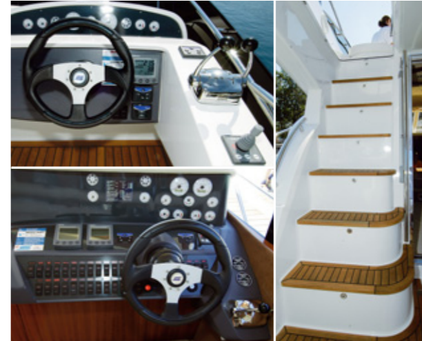
Der Weg vom Innen- zum Aussensteuerstand führt über eine breite und sichere Treppe, die in der Nacht von blauen Spots erhellt wird. Beide Steuerstände sind umfänglich und mit elektronischen Einhebel-Schaltungen ausgerüstet.
