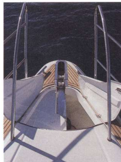
Sehr gute Lösung: hohe Seereling mit offenem Bugkorb und Ankerspriet
