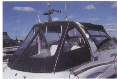
Optimale Passform: Das mehrteilige Cabrioverdeck, Kostenpunkt 2000 EUR, wird von einem deutschen Zulieferer maßangefertigt
