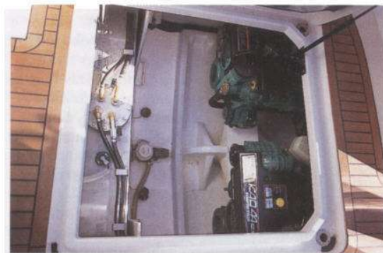
Diesel-Power made by Volvo Penta: Die bewährten Turbodiesel vom Typ KAD 44 P-EDC leisten jeweils 179 kW (243 PS) und beschleunigen die Galia auf respektable 40 Knoten. Gut zu erkennen ist das stabilisierende Spantensystem des handlaminierten Rumpfes
