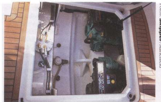
Diesel-Power made by Volvo Penta: Die bewährten Turbodiesel vom Typ KAD 44 P-EDC leisten jeweils 179 kW (243 PS) und beschleunigen die Galia auf respektable 40 Knoten. Gut zu erkennen ist das stabilisierende Spantensystem des handlaminierten Rumpfes
