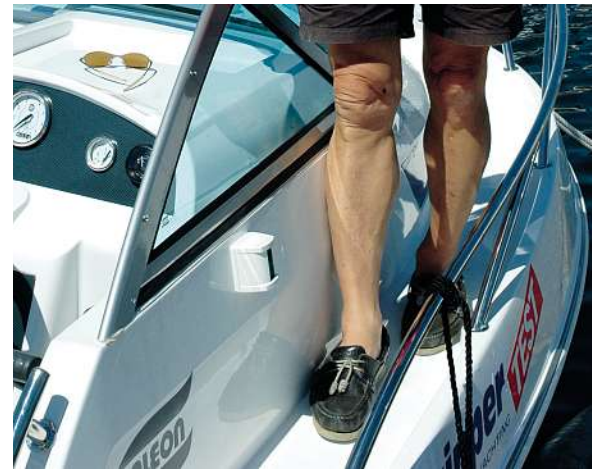
Das rutschhemmend strukturierte, 21 bis 30 cm breite Gangbord erlaubt eine sichere Fortbewegung außerhalb des Cockpits
