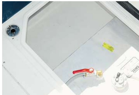
Der 200 Liter fassende Brennstofftank ist serienmäßig mit einem Absperrhahn kombiniert
