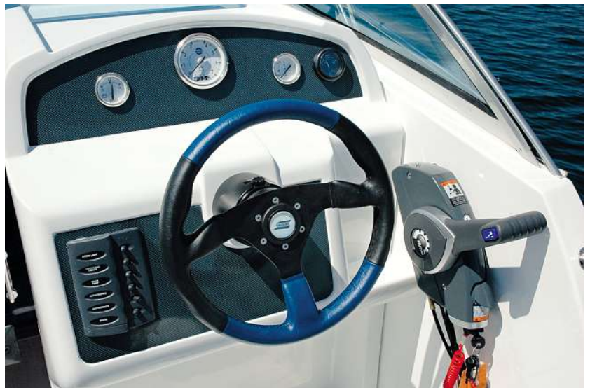
Schlicht gestaltetes Armaturenbrett mit recht weit aus der Konsole herausragendem Ruder, das knappe fünf Umdrehungen zwischen den Anschlagpunkten benötigt
