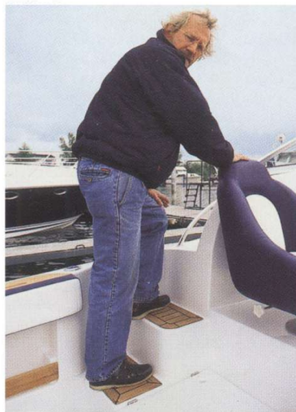
Eine klappbare, sehr stabile Treppe mit zwei Stufen verbindet Cockpit und Kabine
