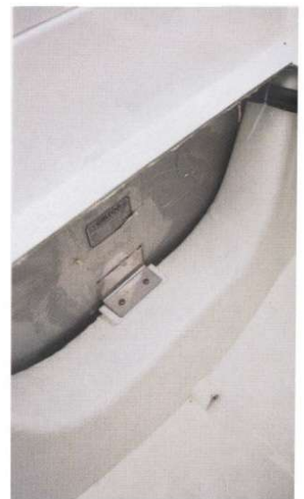
Polnischer Qualitätsbootsbau: Dicke Querversteifungen stabilisieren die GFK-Struktur im Unterwasserbereich und halten den stählernen 300-l-Einbautank in Position
