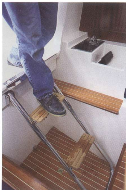
Eine klappbare, sehr stabile Treppe mit zwei Stufen verbindet Cockpit und Kabine
