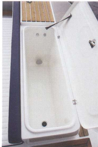
Sportangler aufgepasst: Der große Fang kann achtern in einer praktischen Fischbox mit eingebauter Seewasserpumpe zwischengelagert werden
