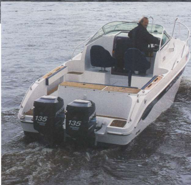
Galia 700 von achtern: Zu beiden Seiten der Motorwanne befinden sich in die Form integrierte Heckstege, backbords gibt es einen 44 cm breiten Durchgang ins Cockpit
