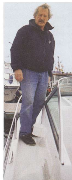
Praktische Lösung: Galeon-Händler Ralf Hartwig demonstriert, wie bequem man vom Cockpit aus auf die umlaufenden, 22 cm breiten Gangborde gelangt, die ihrerseits von einer bis zu zwölf Zentimeter hohen Schanz umgeben werden
