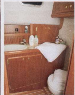
WC-Raum, Stehhöhe 162 cm, mit Marine-Toilette (inclusive Fäkalientank) und Handwaschbecken. In zahlreichen Klappschränken kann Kosmetika aufbewahrt werden
