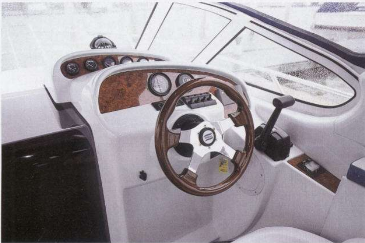
Übersichtliches Armaturenbrett: Die Kontrollinstrumente sind auf zwei Ebenen montiert
