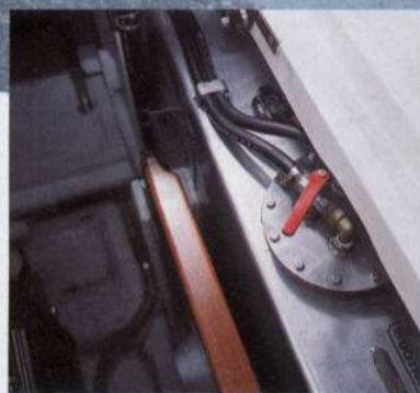
Sicherheitsmerkmal: Griffgünstig positionierter Kraftstoffabsperrhahn auf der Oberkante des stählernen, 400 l fassenden Sprittanks
